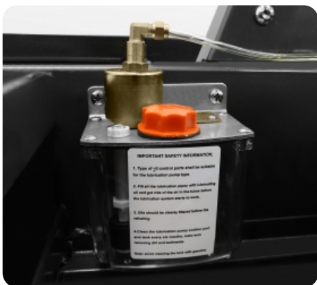
Часть системы автоматического смазывания деки
