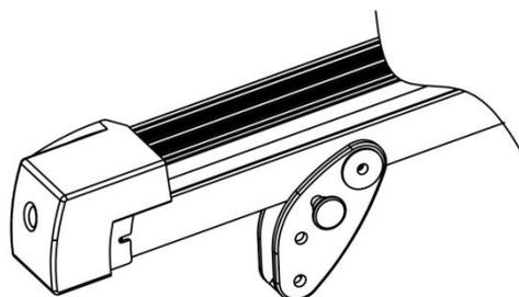
Угол наклона беговой дорожки можно изменить при помощи регулировочного штифта. В тренажёре предусмотрено 3 регулировочных отверстия, каждое из которых соответствует определённому углу наклона (см. рисунок выше). Чтобы установить необходимый для Вас наклон тренажёра, вставьте штифт в отверстие, которое соответствует желаемому углу наклона.
