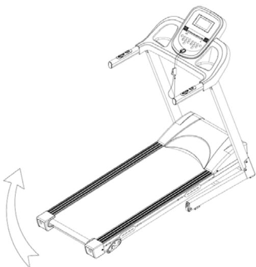
Поднимите беговую платформу к верхней части тренажёра и надавливайте на неё, прилагая усилия до тех пор, пока не услышите щелчок, который показывает, что предохранительный кожух защёлкнулся на пневматическом цилиндре.
