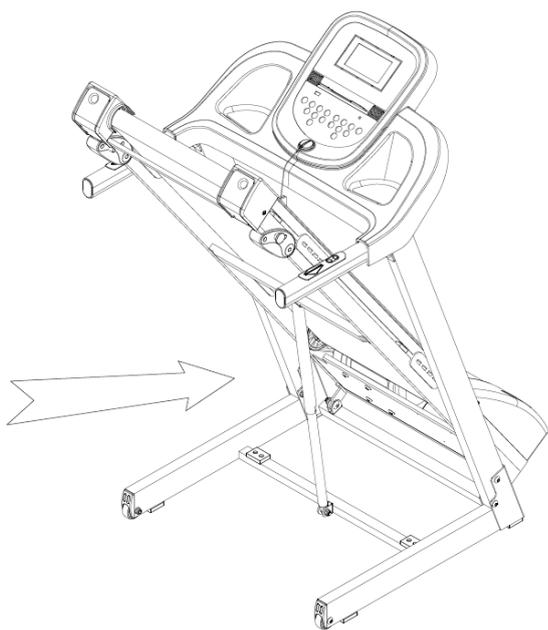
Слегка надавите на предохранительную трубку; продолжайте нажимать на трубку, опуская при этом беговую платформу в направлении, указанном стрелками. После этого тренажёр плавно опустится вниз.
