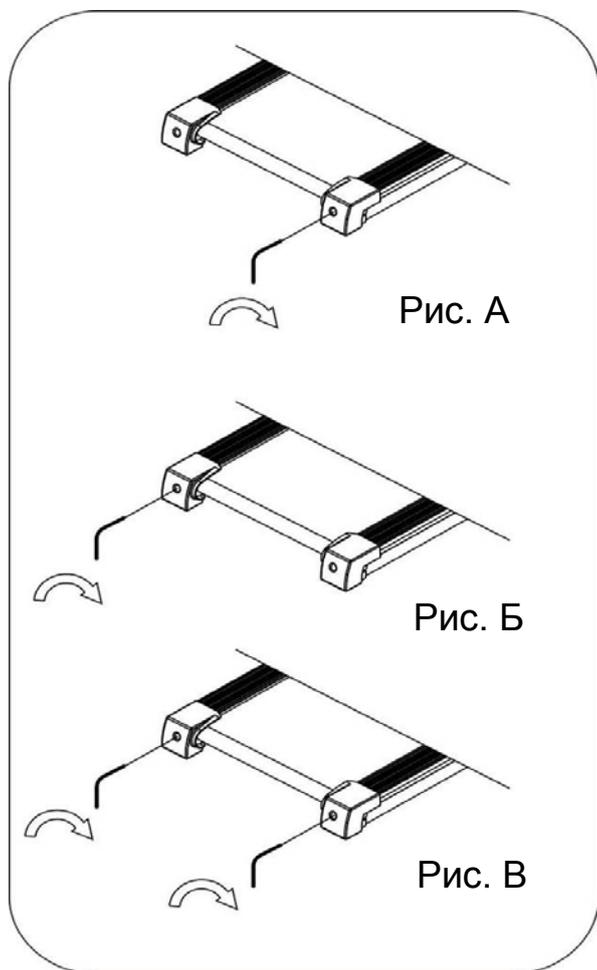
Если беговое полотно сдвигается вправо, извлеките ключ безопасности и выключите электропитание, после чего поверните правый регулировочный болт на 1/4 оборота по часовой стрелке. Затем включите питание, вставьте ключ безопасности и запустите беговую дорожку. После запуска тренажёра проверьте движение бегового полотна. Повторяйте вышеуказанные действия до тех пор, пока полотно не будет расположено по центру. **См. рисунок А**
