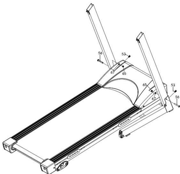
**ШАГ 2 :** Затяните два комплекта деталей (болт M8\*15 (53), болт M8\*45 (56), плоская шайба (67) и контргайка (65)) – по одному с каждой стороны тренажёра.
